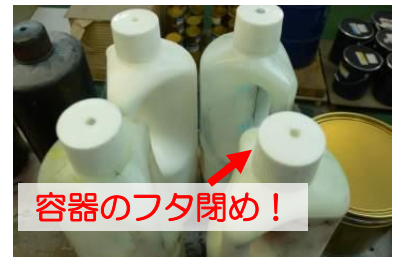
フタ開放で8時間に60gの溶剤が蒸発します。(日本印刷産業連合会 印刷産業におけるVOC排出抑制自主的取組推進マニュアルより)
